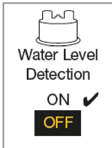
El humidificador activo AIRcon detecta de forma automática el nivel de agua de la cámara humidificadora. Cuando el nivel de agua de la cámara humidificadora sobrepase el valor máximo o sea inferior al nivel mínimo, saltarán las alarmas acústicas y ópticas. Las siguientes opciones seleccionables indican la detección automática del nivel de agua:
